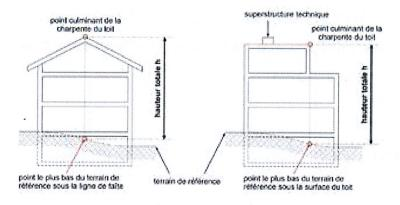
Les superstructures techniques, par exemple celles concernant les ascenseurs, les escaliers, les ventilations, les conduits de fumée ou les installations solaires peuvent dépasser le point culminant de la toiture. Les dispositions de l'Accord intercantonal harmonisant la terminologie dans le domaine de la construction (AIHC) sont applicables.
